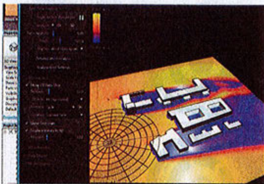
Figure 5. Étude instantanée de la circulation des vents (© Artelia).
